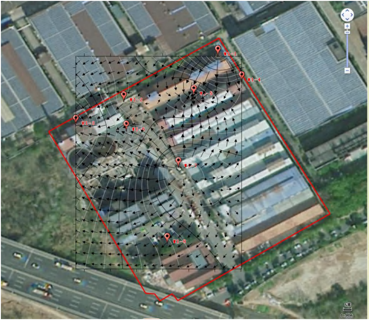
图2.2-4厂区地下水流向图
