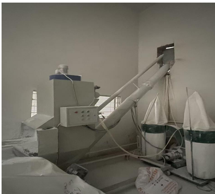
投料粉尘布袋除尘装置
