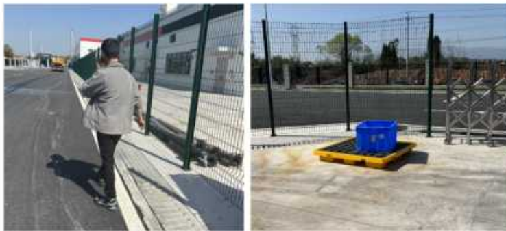
泄露后，叉车司机立即向主管报告，同时使用泄漏托盘将泄漏吨桶运送至化学品卸车区域
