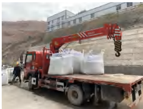
图 4-6 飞灰吨袋敞开式运输
