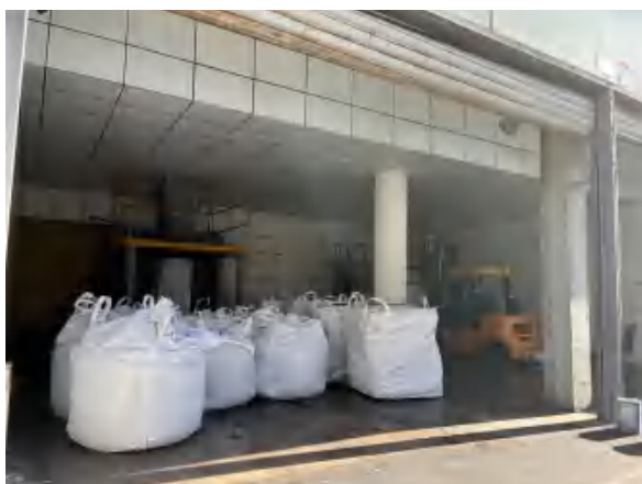
图 4-5 飞灰固化收集装袋区
