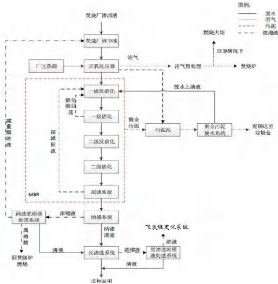
图 2.2.1-2 渗滤液处理工艺流程
