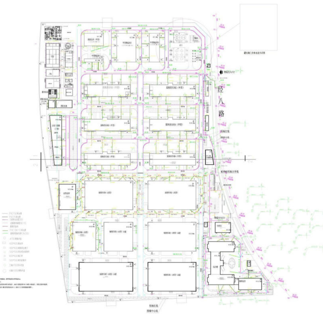
浙江赛默制药有限公司雨水总平面布置图
