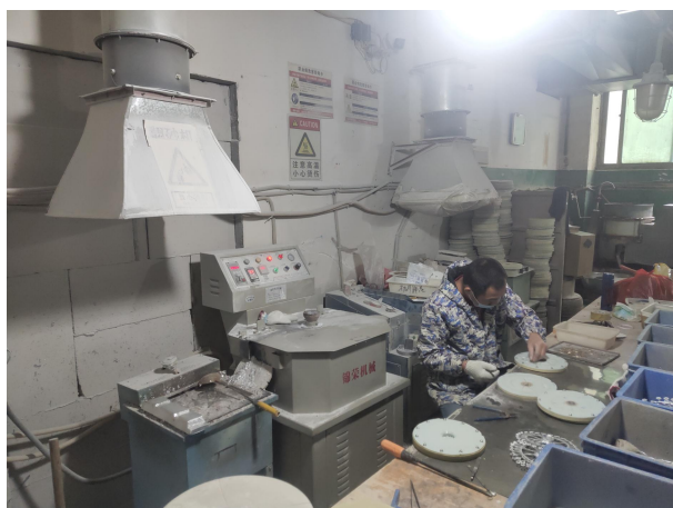
翻砂车间防护设施
